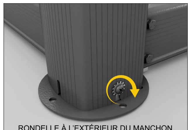
FIGURE 34: SERRER LA VIS AU BAS DE CHAQUE MANCHON
