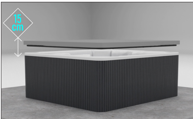
FIGURE 68: ABAISSER LE COUVERCLE 15 CM AU-DESSUS DU SPA ET VÉRIFIER QUE LES COINS SONT À LA MÊME HAUTEUR
