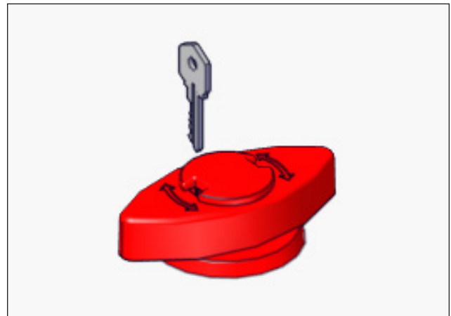
FIGURE 90: INSÉREZ LA CLÉ COVANA OU N'IMPORTE QUELLE CLÉ DANS UNE DES FENTES
