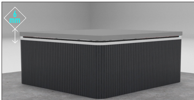
FIGURE 68: ABAISSER LE COUVERCLE 6 MM AU-DESSUS DU JOINT POUR VÉRIFIER LA POSITION DU JOINT
