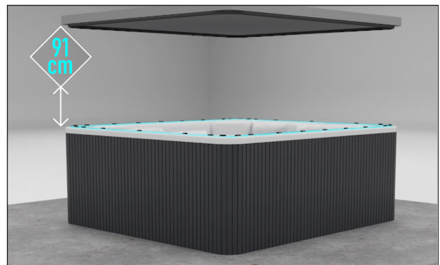
FIGURE 72: LORSQUE LE JOINT EST DÉGAGÉ, REMONTER LE COUVERCLE DE 91 CM
