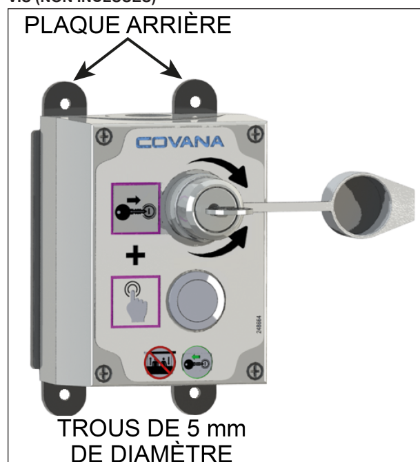
FIGURE 50: FIXER LA PLAQUE ARRIÈRE AVEC QUATRE VIS (NON INCLUSES)
